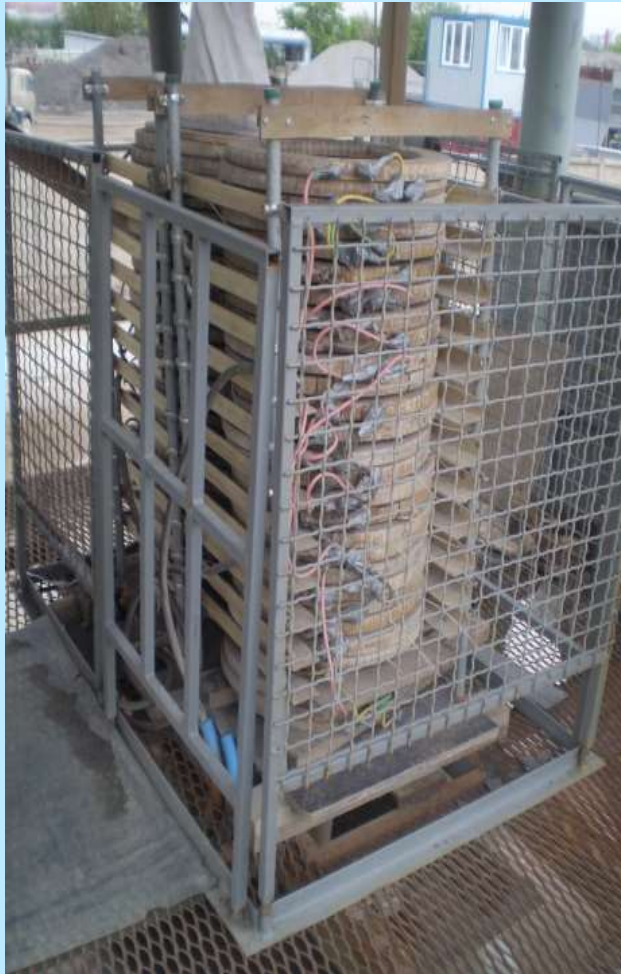
Аппарат ЭМАКС с магнитокипящим слоем для измельчения материалов
