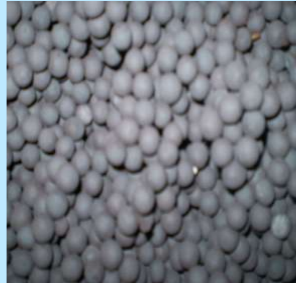
Рабочие тела – постоянные магниты (гранулы сферической формы) для обработки материалов
