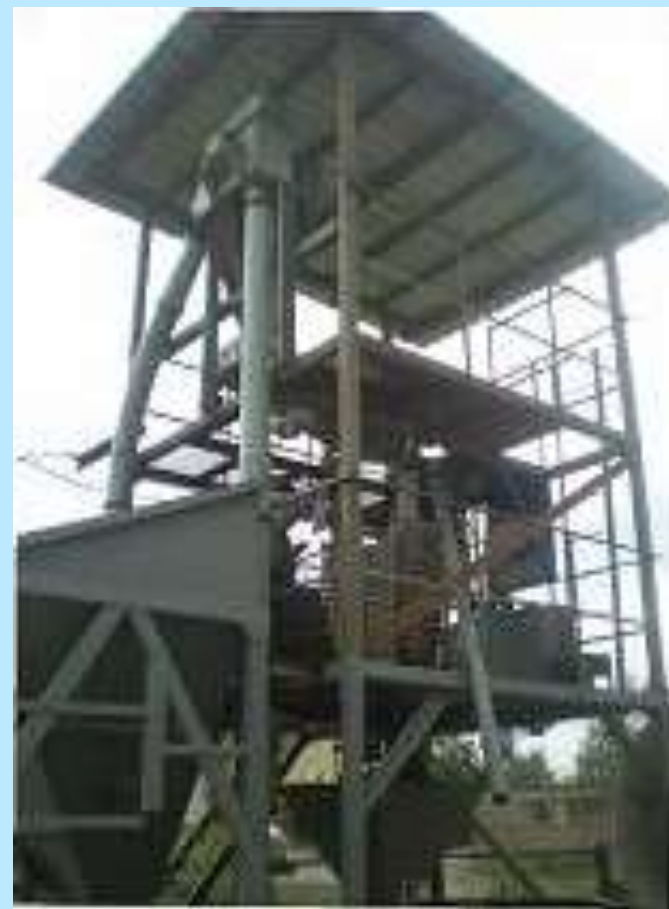
Аппарат ЭМАКС вертикального типа непрерывного действия для измельчения различных материалов
