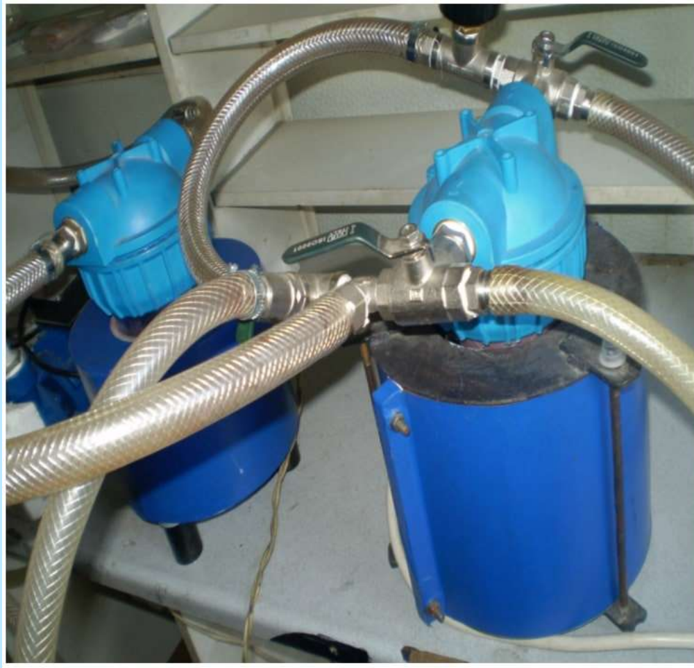
Лабораторный аппарат ЭМАКС и электромагнитный фильтр предназначенные для отработки технологий по очистке сточных вод
