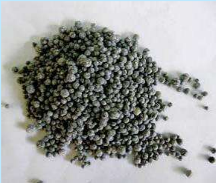
Пеностеклогранулят из стеклобоя и водопроводного осадка
